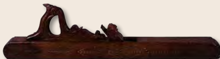
Garlopa (S.XVIII) Museo Naval de Madrid Utilizada para igualar las superficies de la madera de los buques
