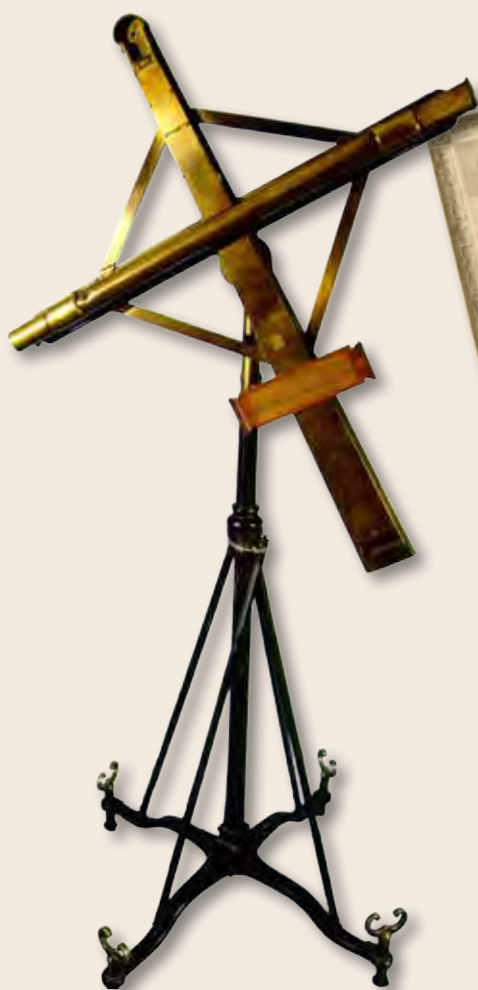
Nivel geodésico (S.XVIII), utilizado por Jorge Juan en la medición del meridiano Museo Naval de Madrid
