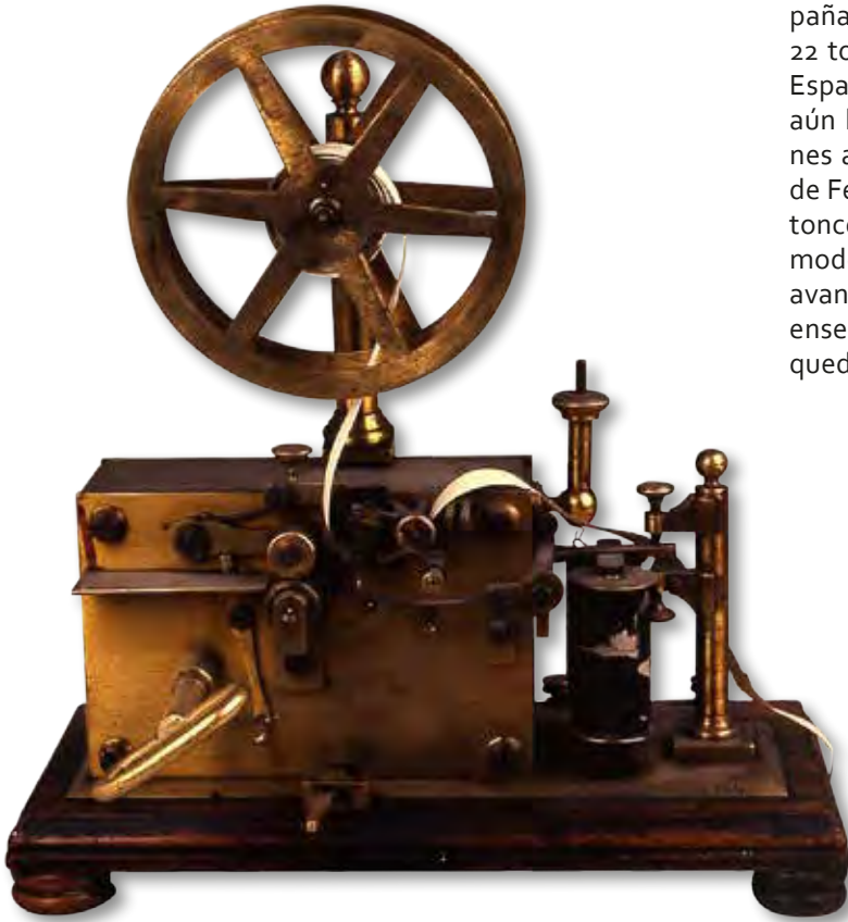
Receptor de telégrafo por cable sistema Morse (S.XIX) Museo Naval de Madrid
