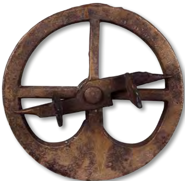
Astrolabio náutico (S.XVI) Museo Naval de Madrid El astrolabio náutico fue, seguramente, el instrumento de altura que más contribuyó a los descubrimientos
