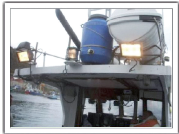
Figura 11. Parte superior de la cabina de mando. Balsa salvavidas y depósito agua dulce
